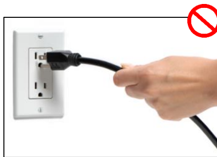
Fig.1 – Interdit de tirer sur le câble
