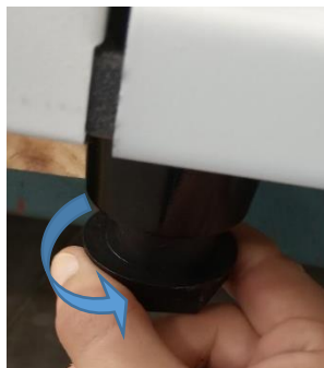
Fig. 7 - Colocação do nivelador no pé do equipamento
