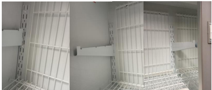
Abb. 10 - Einsetzen der Halterung
