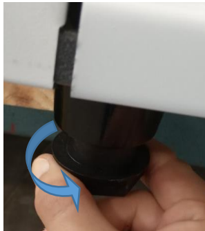
Abb. 7 - Anbringung des Nivellierfußes am
