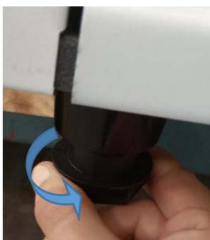
Fig. 7 - Mise en place du niveleur sur le pied de l'équipement
