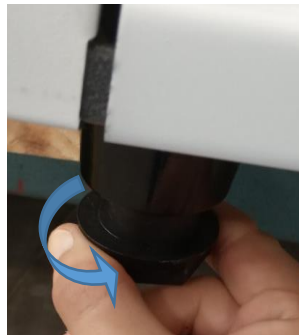
Fig. 7. Colocación del tornillo regulador en la pata del equipo
